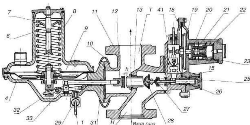
Регулятор давления газа РДНК: 1 — импульсная трубка; 6, 20, 21, 27, 33 — пружины; 4, 18 — мембрана; 7 — нажимная гайка; 8 — стакан; 9 — мембранная камера; 10 — хомут; 11 — корпус; 12 — рабочий клапан; 13 — седло; Т — выходной патрубок; 15 — фиксатор; 19 — отключающее устройство; 22, 23 — регулировочные гайки; 25 — пробка; 26, 31 — штоки; 28 — отсечной клапан; 29 — тройник; 32 — рычажной механизм; 41 — исполнительный механизм; Н — входной патрубок
